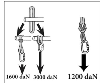
ジャミーはソウンスリングとしても使えますが、結び目によりソウンスリングの強度は低下します。
