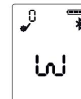
**W** Avvertenza: tutte le caratteristiche fondamentali funzionano correttamente, ma alcune caratteristiche opzionali (ad esempio, motore vibrante) sono disabilitate. Premere il pulsante **FUNZIONE** per passare alla modalità SEND: ora si può partire! È consigliabile eseguire un controllo del dispositivo utilizzando l'app PIEPS per ottenere ulteriori informazioni sull'avvertenza e, se necessario, rivolgersi al servizio di assistenza di PIEPS.
